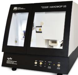
«НАНОФОР 05» – прибор открытого типа, 8-капиллярный, имеет 7 каналов детекции флуоресценции
